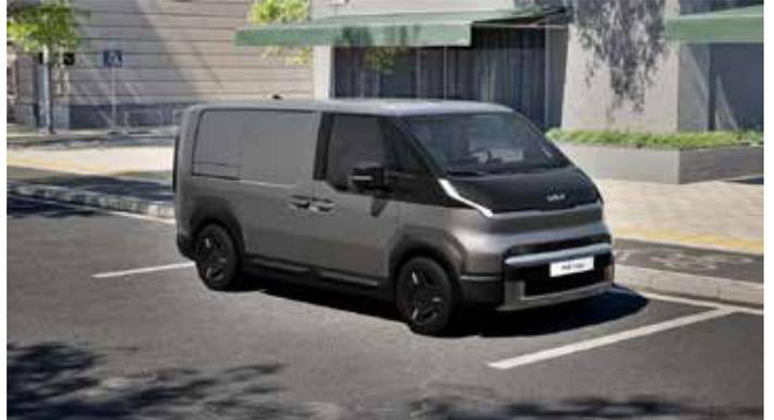
Kia bringt mit dem PV5 Cargo einen flexiblen vollelektrischen Transporter mit bis zu 4400 l Ladevolumen, 1500 kg Anhängelast und bis zu 416 km Reichweite (2 Batteriegrößen) auf den Markt.
