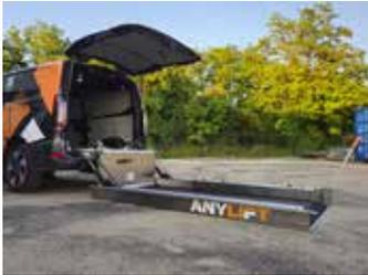
Die Ladung am Boden laden, sichern und elektrisch ins Fahrzeug hochheben und einfahren. So einfach geht das mit dem Hubladesystem ANYLIFT für Kastenwagen/LNF. ANYLIFT kann ihr Logistik nachhaltig verändern!
